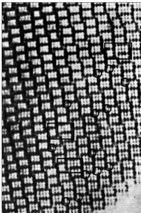
Рис. 38. Окисленная структура \text{Nb}_{25}\text{O}_{62} , состоящая главным образом из столбиков 3 \times 4 октаэдра ( 2 \times 3 светлых канала), но имеются также 3 \times 3 , 3 \times 5 столбики и неправильные соединения разных столбиков [99]
