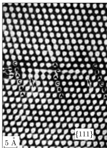
Рис. 35. Ошибка слоев в плотной кубической упаковке атомов золота [41]
