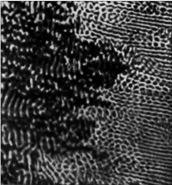
Рис. 13. Два типа доменов, возникающих в тонких слоях параазоксианизола при наложении электрического поля (предварительно ориентированный в горизонтальном направлении образец)
