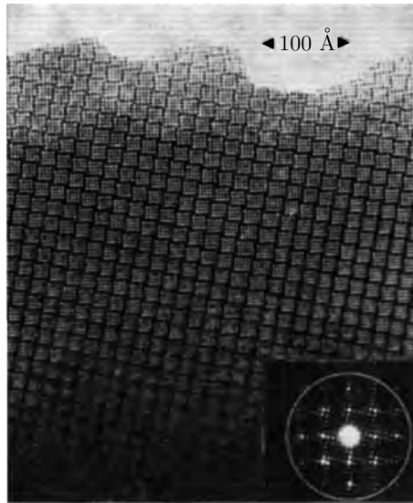
Рис. 7. Эм-фотография структуры сложного окисла 9\text{Nb}_2\text{O}_5 \cdot 8\text{WO}_3 и соответствующая ей дифракционная картина [34]. Радиус апертуры (кружок) 0,60 \text{ \AA}^{-1} . Разрешение около 2 \text{ \AA}
