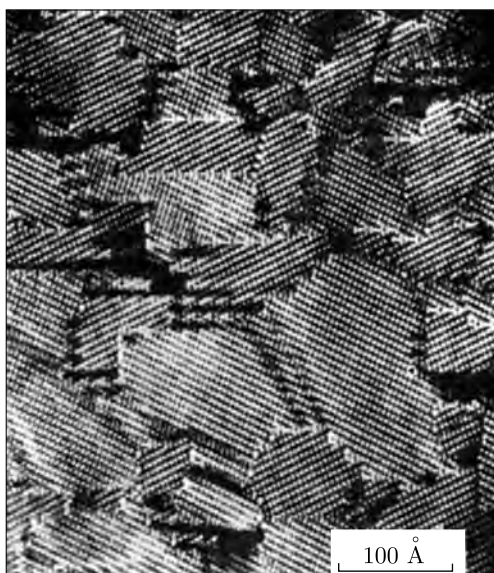
Рис. 44. «Ковер» из доменов в сплаве \text{Au}_5\text{Mn}_2 после отжига [105]. Границы доменов часто представляют собой двойники соприкасающихся кубических упаковок
