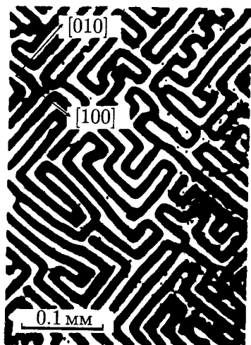
Рис. 2.6. Промежуточное состояние монокристаллической оловянной фольги толщиной 29 мкм в перпендикулярном поле [19].
