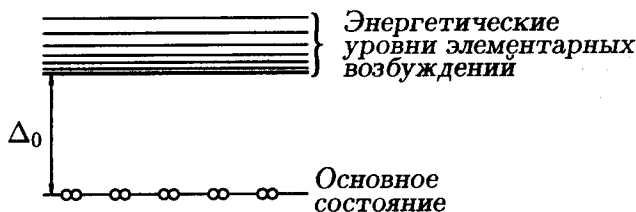
Рис. 45.1. Энергетическая щель \Delta_0 отделяет область энергетических уровней элементарных возбуждений от уровня основного состояния (уровня конденсации электронных пар).
