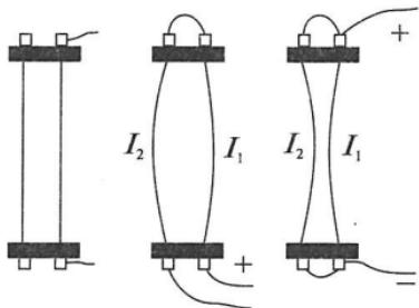
Единица силы тока в СИ — ампер. Сила тока равна 1 А, если между отрезками двух бесконечных проводников, по 1 м каждый, находящимися в вакууме на расстоянии 1 м друг от друга, действует сила магнитного взаимодействия  $2 \cdot 10^{-7}$  Н:
