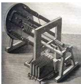
Электродвигатель Б. С. Якоби конструкции 1834 г.
