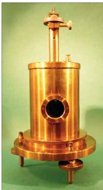
Квадрантный электрометр Долезалека (1895 г.).
