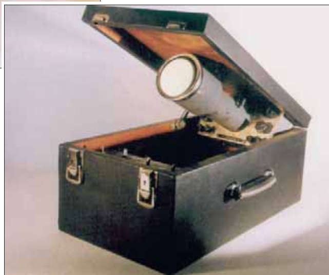
Реконструированная модель осциллографа, на котором Евгений Завойский впервые зафиксировал сигнал ЭПР.
