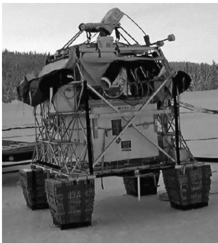
Рис. 65. Гетеродинный спектрометр TELIS
