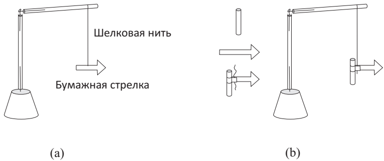
Рис. 2.11: Электрический маятник с подвешенной стрелкой.
