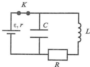
**Проверь себя:** В этой электрической цепи ток через конденсатор не идёт. Согласно закону Ома для полной цепи:  $I = \frac{\epsilon}{R+r}$  (считаем, что катушка идеальная). Тогда на конденсаторе и резисторе напряжения одинаковые, равные:  $U = IR = \frac{\epsilon R}{R+r}$ .
